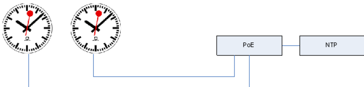
Slika 14: Shematska risba povezave notranjih in zunanjih ur z NTP strežnikom
